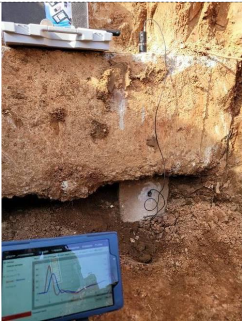
Фото 116 Определение длины свай в шурфе № 1
