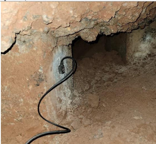
Фото 120 Определение длины свай в шурфе № 2
