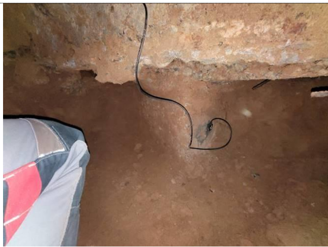
Фото 128 Определение длины свай в шурфе № 5
